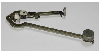
Obr. 3: Amslerův polární planimetr. Kratší rameno s integračním kolečkem odpovídá pohybuující se úsečce. Pravý konec opisuje hranici měřené množiny, levý konec úsečky je v místě spoje obou ramen. Zdroj: wikimedia.org
