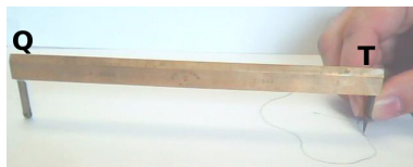
Obr. 2: Měření Prytzovým planimetrem. Uživatel při měření drží hrot T ve vzpřímené poloze, konec Q se volně pohybuje. U tohoto planimetru je v bodě Q malé ostré kolečko.
