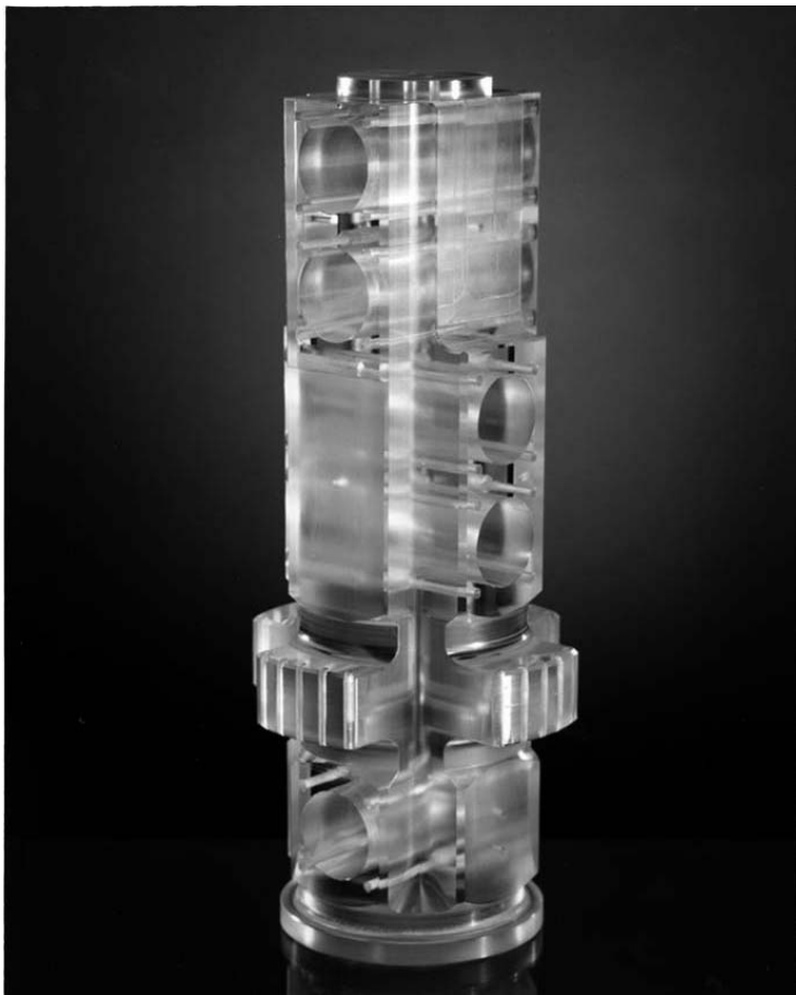
Obr. 6. Blok křemene, ve kterém jsou uloženy gyroskopy. V horní části jsou patrné čtyři válcové tunely připravené pro uložení gyroskopů. (Foto: GPB, Stanford University.)
