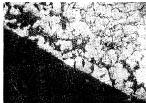
4. Koroze mosazi v \text{NaOH} 80 % Zvětšení 470 \times . Vypočtená hloubka proniknutí koroze 0,064 mm.
