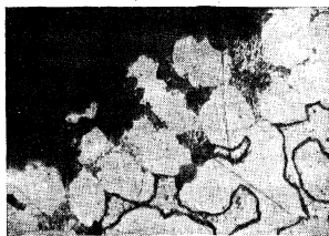
6. Koroze mosazi v \text{HNO}_3 , h 1,1. Zvětšení 470 \times . Vypočtená hloubka proniknutí koroze 0,070 mm.
