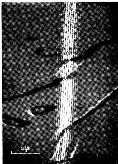
Obr. 9. Otisk bílé litiny v interferenčním elektronovém mikroskopu.
