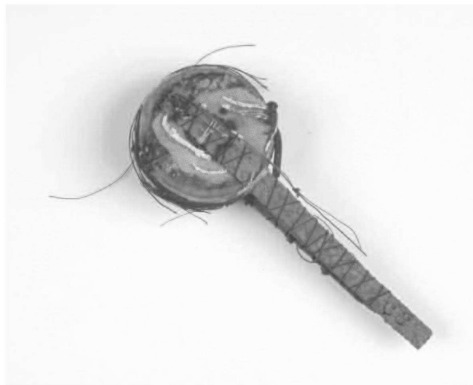
Obr. 6. Cívka z olověného drátu (pohled ve směru osy cívky), kterou v roce 1912 používal Kamerlingh Onnes a jeho spolupracovníci, je nyní uchovávána v muzeu Boerhaave.
