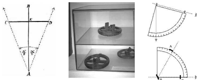
Obr. 6. Jakubova hůl, námořní astroláb, schéma kvadrantu
