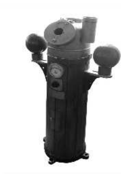
Obr. 4. Námořní magnetický kompas, magnetická deklinace
